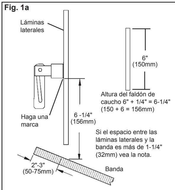
**1. Determine la posición correcta de los pasadores de la mordaza en las láminas laterales.** Mida la altura del faldón material y sume 1/4" (6mm). Con esa medida, mida desde la superficie de la banda hasta las láminas laterales y haga una marca (Fig. 1a). Repita esto varias veces hacia las láminas laterales y dibuje una línea que conecte las marcas (Fig. 1b).
