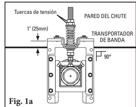
1. **Instale las bases de montaje del tensor de resorte.** Con una mordaza coloque la base de montaje en posición de manera que la brida superior de la base esté 1" (25mm) sobre la banda (Fig. 1). Atornille o suelde la base de montaje en su lugar. Ubique e instale la base de montaje en el lado opuesto.
