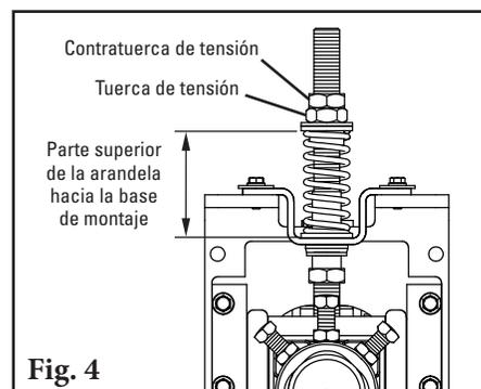
**5. Lleve a cabo las pruebas del transportador e inspeccione el rendimiento de limpieza.** Si hay vibración o desea más eficiencia de limpieza, aumente la tensión de la hoja haciendo ajustes de compresión de 1/8" (3mm) en los resortes de tensión.
