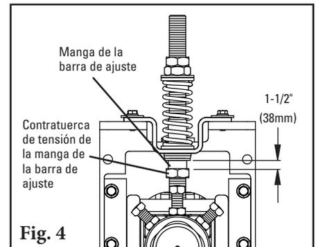
6. **Lleve a cabo las pruebas del limpiador e inspeccione el rendimiento de limpieza.** Si hay vibración o desea más eficiencia de limpieza, aumente la tensión de la hoja haciendo ajustes de compresión de 1/8" (3mm) en los resortes de tensión.
