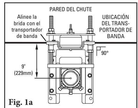
1. **Instale las bases de montaje del tensor de aire/agua.** Con una mordaza coloque la base de montaje en posición de manera que la base esté alineada con la banda (Fig. 1). Atornille la base de montaje en el lugar. Ubique e instale la base de montaje en el lado opuesto.
