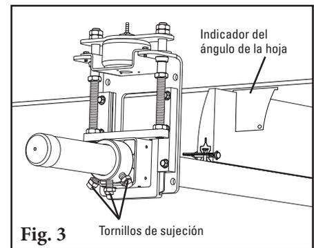
4. **Establezca la manga de la barra de ajuste.** Después de establecer la tensión de la hoja, atornille la manga de la barra de ajuste en el buje UHMW hasta que se muestre 1-1/2" (38mm) (Fig. 4). Apriete la contratuerca de tensión de la manga de la barra de ajuste.
