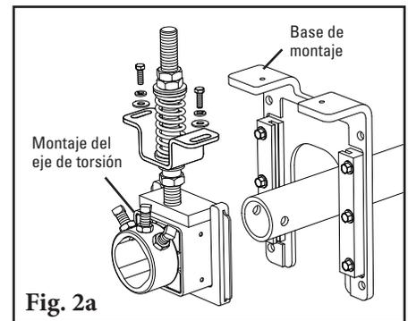
4. **Establezca la tensión de la hoja.** Afloje las contratuercas de tensión superiores en ambos lados. Gire las tuercas de tensión hasta que se haya alcanzado la compresión correcta del resorte. La compresión del resorte es determinada por la longitud del resorte. Consulte la tabla anterior para conocer la longitud correcta del resorte para su ancho de banda.
