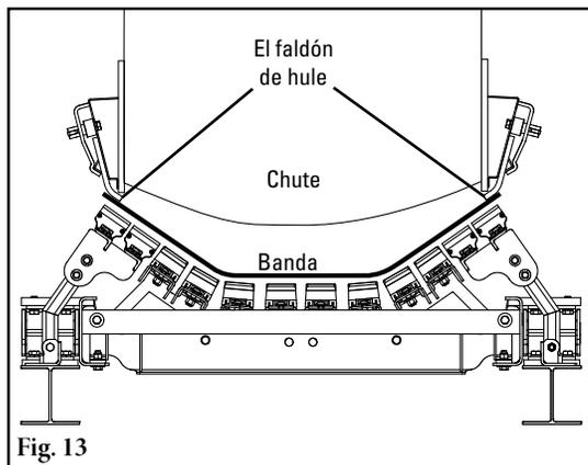
13. **Confirme el espacio correcto entre el chute y la banda.** Vuelva a ajustar el faldón de hule para realizar un buen sellado contra la cama de impacto (Fig. 13). Reemplace toda la protección alrededor de la zona de carga.
