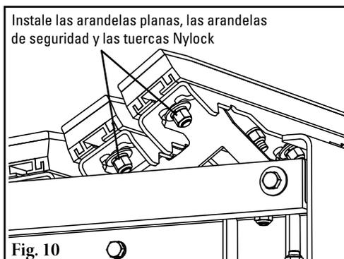
10. **Ajuste las barras de impacto.** Con todas las barras de impacto colocadas correctamente en los soportes de extensión, instale una arandela plana, arandela de bloque y tuerca nylock en cada soporte. Apriete las tuercas a una torsión de 100 pies-lb (135 N-m) (Fig. 10). Quite las mordazas en C de los amortiguadores.
