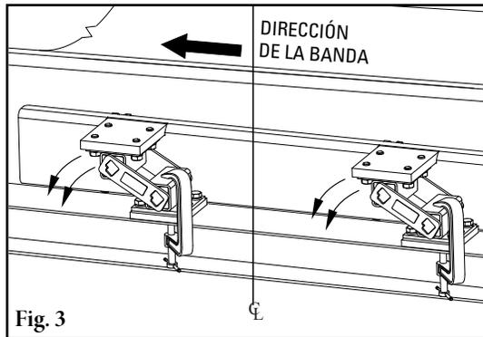
Mida a un punto fijo en la estructura y luego transfiera esta dimensión al lado opuesto de la estructura.
