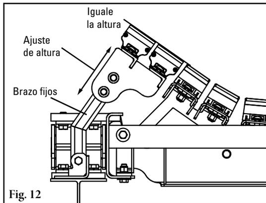
12. **Ajuste los brazos fijos.** Afloje los pernos superiores en los brazos fijos y ajuste la altura para que coincida con la banda y el chute. Vuelva a apretar los tornillos. Termine de soldar los brazos en su lugar sobre la estructura (Fig. 12).
