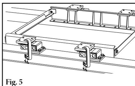
5. **Coloque los rieles de suspensión.** Comprima los rieles de suspensión con cuatro mordazas C para proporcionar un espacio libre adicional de 2.5" (63mm) para el ensamble (Fig. 5).
