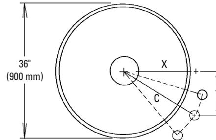
1. **Determine las medidas de ubicación dadas y defina el cambio necesario.** Después de determinar las medidas X y Y, determine la distancia de la modificación necesaria para obtener un espacio adecuado para el eje y sistema de tensión. (En el ejemplo decidimos bajar el eje 2" (50 mm) para liberar la estructura de soporte).
