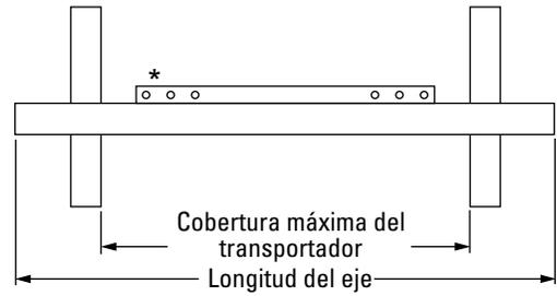
\* Cada tamaño de husillo se puede utilizar con un tamaño de hoja de cualquier ancho de banda menos 150 mm, 300 mm, 450 mm, 600 mm, 750 mm o 900 mm.
