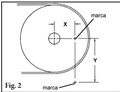
2. **Trace las medidas en la pared del chute.** Tome la medida de X horizontalmente desde el centro del eje de la polea y marque.
