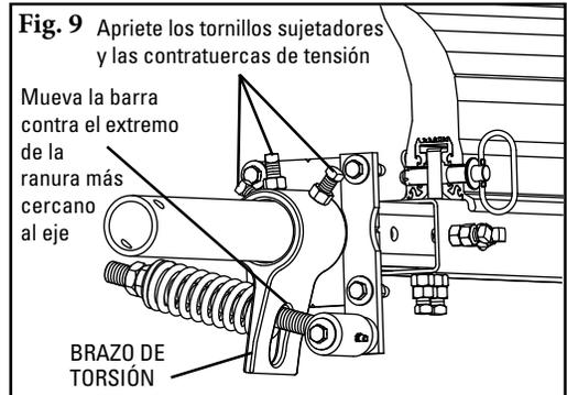
**10S. Establezca la tensión correcta de la hoja.** Consulte la tabla en el soporte del eje de pivote para obtener la longitud requerida para el ancho de la banda. Jale levemente el brazo del pivote hacia el extremo de la ranura del brazo de torsión cercano al eje y gire las tuercas de ajuste hasta que se logre la longitud del resorte requerida (Figura 10).
