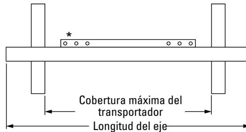
\*Cada tamaño de eje se puede usar con un tamaño de hoja ya sea del ancho de la banda menos 6" (150mm), ancho de la banda menos 12" (300mm) o ancho de la banda menos 18" (450mm).
