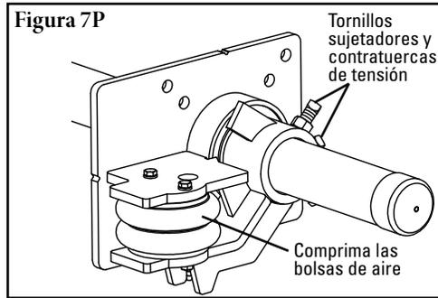
**NOTA:** Los tensores PAT se envían con bolsas de aire y brazos de torsión sujetos en las bases de montaje.
