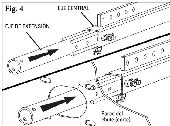
4. **Arme los ejes de extensión al eje central.** Inserte los ejes de extensión a través de los orificios del chute y en el eje central (Fig. 4). No apriete los tornillos sujetadores.
