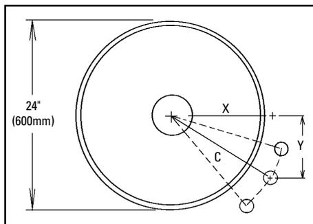
1. **Determine las medidas de ubicación dadas y defina el cambio necesario.** Después de determinar las medidas X y Y, determine la distancia de la modificación necesaria para obtener un espacio adecuado para el eje y sistema de tensión. (En el ejemplo decidimos bajar el eje 2" (50 mm) para liberar la estructura de soporte).
