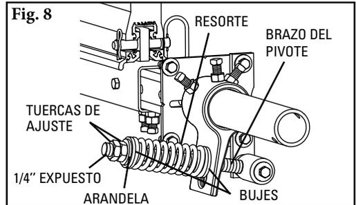
**9S. Aplique tensión a la hoja en la banda.** Gire la hoja hasta que haga contacto con la banda. Mientras sostiene el buje del resorte fijo sobre el brazo de torsión, gire el brazo de torsión hasta que el brazo del pivote quede contra el extremo de la ranura más cercana al eje. Apriete los tornillos sujetadores y las contratuercas de tensión en el brazo de torsión (Fig. 9). **NOTA:** El brazo de torsión debe estar contra la placa de montaje.
