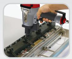
**仮止め:** ファスナーとベルトをベースに挿入してトリガーを引くだけで、ステープルがベルトに打ち込まれます。
