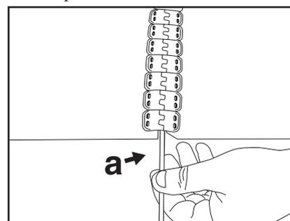
15. Junte as extremidades da correia e insira o pino de união. Se for usada a arruela de retenção, fixe com o alicate. A emenda está pronta.
