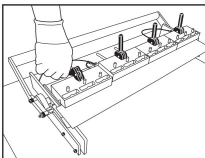
8. (a) A extremidade da correia deve ficar firme nos batentes da correia dos grampos. (b) Pressione a(s) alavanca(s) came. A parte de cima do grampo deve inclinar-se para frente. Caso contrário, aperte a alça no sentido horário para aumentar a pressão e repita o procedimento. Para evitar danos ao instrumento, não aperte alavancas do came.
