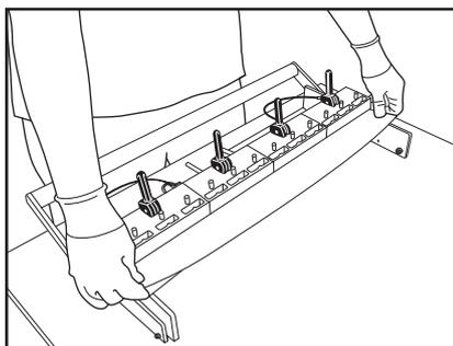
7. Centralize a tira de grampos na ferramenta. Aperte a tira de grampos contra a ferramenta. (a) A(s) alavanca(s) came deve(m) estar virada(s) para cima. Centralize a correia na ferramenta de instalação e iguale a distância entre as extremidades da correia.
