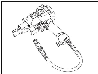
1. Não remova o conjunto do cabo regulador. Conecte o grampeador Alligator® Gold Class™ (número do modelo 55541) a uma tubulação de ar limpa e seca com pressão de entrada máxima de 827370,8 Pa. O regulador do grampeador irá regular a fonte de ar até 482633 Pa. Lubrifique a tubulação de ar com uma ou duas gotas de óleo antes do uso.
