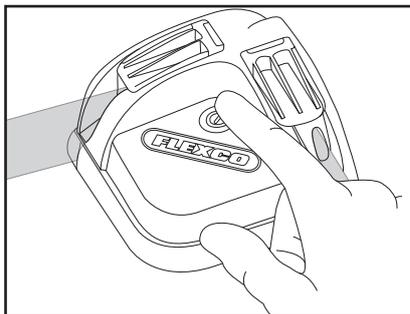
2. (a) Ajuste as extremidades da correia em esquadro. (b) Corte a correia usando uma ferramenta de corte Flexco para correias.
