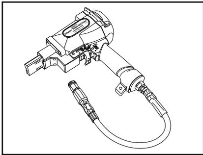
1. Não remova o conjunto do cabo regulador. Conecte o grampeador Alligator® Gold Class™ a uma tubulação de ar limpa e seca com pressão de entrada máxima de 827370,8 Pa. O regulador do grampeador irá regular a fonte de ar até 482633 Pa. Lubrifique a tubulação de ar com uma ou duas gotas de óleo antes do uso.
