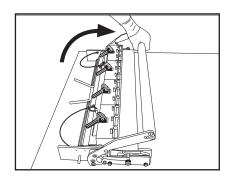
12. Déplacez la poignée de la position initiale à la position finale pour placer l'enclume en position de finition.
