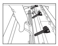
11. Pressez les deux poignées de déverrouillage pour permettre à l'outil de changer de position.
