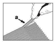
3. (a) Rabotez la surface rugueuse de la bande à l'aide d'un outil Flexco. Choisissez la taille d'agrafe appropriée à l'aide du tableau de la page 7.
