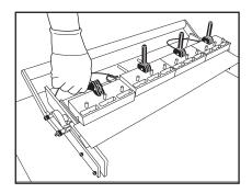
8. (a) L'extrémité de la bande doit être tout contre les butées des agrafes. (b) Abaissez le ou les leviers à came. Le haut des agrafes devrait pencher vers l'avant. Si ce n'est pas le cas, serrez la poignée en la tournant dans le sens des aiguilles d'une montre pour augmenter la pression et recommencez. Pour éviter d'endommager l'outil, ne pas trop serrer les leviers de came.
