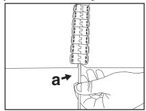
15. Réunissez les deux extrémités de la bande et insérez l'axe d'articulation. Si une rondelle de sûreté est utilisée, sertissez-la à l'aide de pinces. La jonction est terminée.
