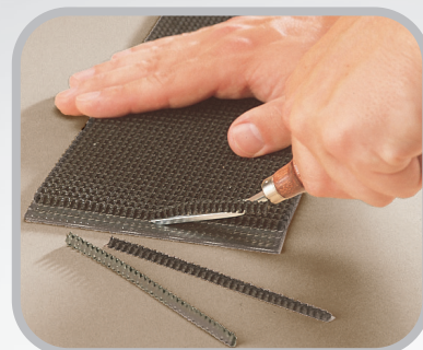
インプレッションカバーをスカイバーで削り取ります。
