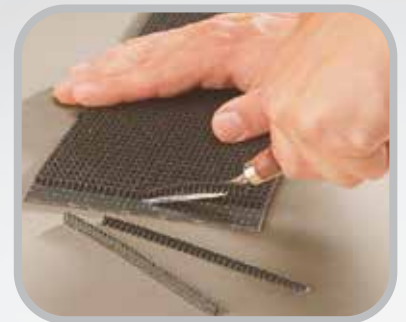
インプレッションカバーをスカイバーで削り取ります。
