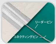
直径の小さなピンと材料の柔軟性を考えると、コネクティングピンの取付けには困難が伴います。このプロセスを簡単にすばやく行えるようご提供しているのが、小径の剛性リードピンを大径の軟性コネクティングピンを大なも、コネクティングピンをスムーズに通せます。リーダーピンを使用することで、多くの場合にピン挿入にかる。時間が75%以上短縮されます。
