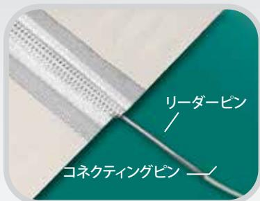
直径の小さなピンと材料の柔軟性を考えると、コネクティングピンの取付けには困難が伴います。このプロセスを簡単にすばやく行えるようご提供しているのが、小径の剛性リードピンを大径の軟性コネクティングピンに装着する「リーダーピン」です。リーダーピンを簡単にエンドレスに挿入でき、コネクティングピンをスムーズに通せます。リーダーピンを使用することで、多くの場合にピン挿入にかかる時間が75%以上短縮されます。
