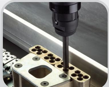
La instalación de las grapas abisagradas con remaches de Flexco SR™ con la Hilti DX 460-SR permite al operador instalar varios empalmes, ocasionalmente poca o ninguna fatiga.
