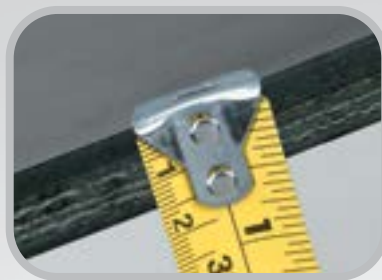
测量输送带厚度。
