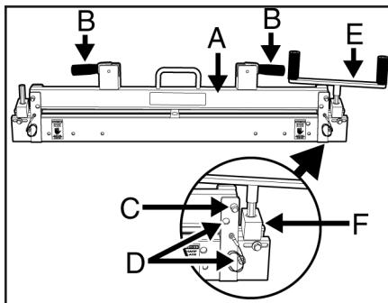
**A:** Clamp Bar, Barra Sujetadora, Klemmschiene, Rail de serrage
