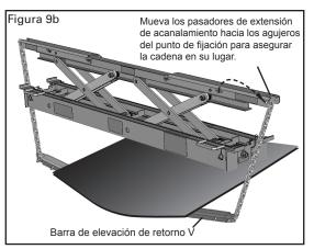
PASO 10. Levante la banda. Gire la tuerca de ajuste hacia la izquierda hasta que la banda esté a la altura deseada. (Utilice eldado de 15/16" (24 mm) y la herramienta, no se incluyen). Retire el ratchet o la herramienta eléctrica antes de empezar a trabajar.
