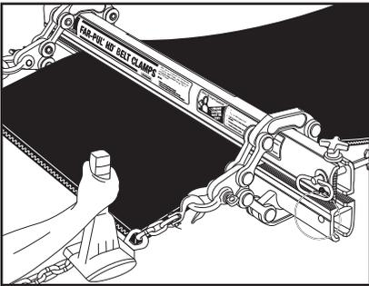
7. After maintenance is complete, release tension on both come-along chains. Remove hooks from shackles on scissors. Remove retaining pins and scissors. **Después** de completar el mantenimiento, liberar la tensión del tecele al largo de las cadenas. Quitar los ganchos de cadenas a las tijeras. Quite los pasadores de retención y tijeras.
