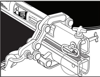
4. Slide scissors against belt edges. Insert Retaining Pins and secure locking mechanism. Do not retighten pre-clamping screws once the scissors are on the tool. **Deslizar** las tijeras contra los bordes. Inserte el pasador de retención y asegure el mecanismo de bloqueo. No vuelva a apretar los tornillos de pre-ajuste de la mordaza de una vez las tijeras están en la herramienta.
