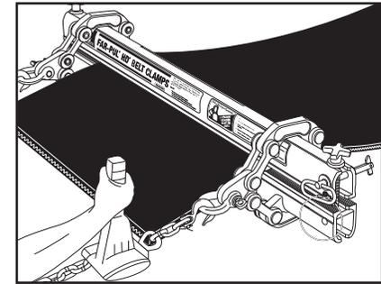
6. Evenly apply tension to pull belt to desired position. Danger – Never exceed 3 ton (2.7 metric ton) capacity. Do not attach to the pre-clamping screw. **Aplicar** tensión uniformemente para tirar (halar) la correa a la posición deseada. Peligro—Nunca exceder la capacidad de 3 toneladas (2,7 toneladas métricas). No adjuntar el tornillo de pre-ajuste de la mordaza.
