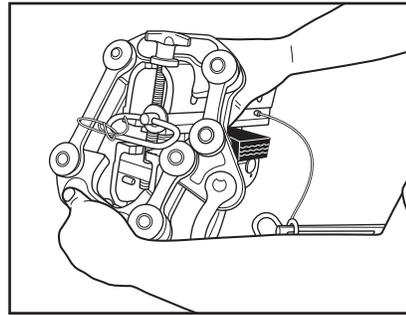
8. Simultaneously release both pre-clamping screws and move to their horizontal position. Make sure to support lower clamp bar during process. **Al mismo tiempo** suelte ambos tornillos de sujeción y pasar a su posición horizontal. Asegúrese de apoyar barra de sujeción inferior durante el proceso.
