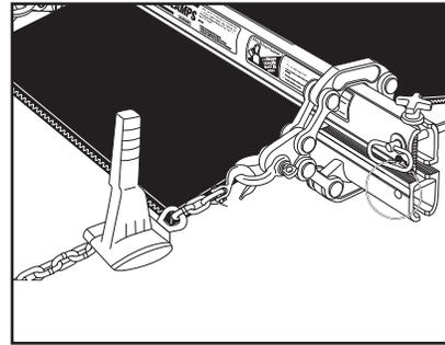
5. Securely attach hooks on come-along chain to shackles on scissors. **Junta** los ganchos en la cadena tirante seguramente a los grilletes en las tijeras.
