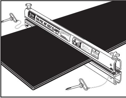
1. Place upper and lower clamp bars on belt, engaging hex alignment pins in alignment slots. **Colocar** las barras de abrazadera superiores e inferiores sobre la correa, engranando las clavijas de alineación en las ranuras de alineación.
