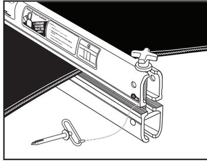
2. Move pre-clamping screw to the upright position and tighten screw by turning clockwise. Do this on both sides. Hand-tighten only. **Mover** el tornillo de pre-ajuste de la mordaza a la posición vertical y apretar el tornillo dando vuelta en sentido a las manecillas del reloj. Hacer esto en ambos lados. Apretar a mano solamente.
