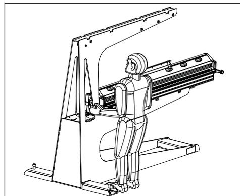
El empalme adecuado requiere que se aplique el peso completo de la viga superior a la banda
