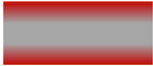
热量未完全穿透输送带厚度的示例
