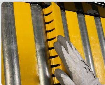
**易于安装：**从侧面摇动着插入托辊间隙。
