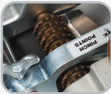
Rodillos impulsores delanteros que sujetan fuertemente la banda al inicio de la rebaja para evitar deslizamientos.
