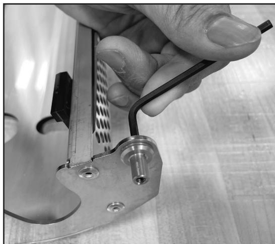
2. Entfernen Sie mit dem mitgelieferten 3-mm-Sechskantschlüssel die aktuellen Drehzapfen auf beiden Seiten des Hitzeschildschutzes und entsorgen Sie die Verbinder und den Drehzapfen. **Hinweis:** Wenn sich der Zapfen dreht, halten Sie ihn mit einer Zange fest.
