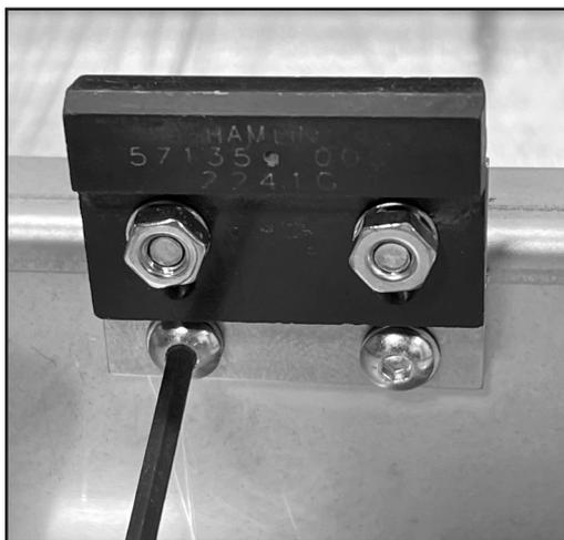
1b. Montieren Sie das Magnet-/Verlängerungsplatten-Set aus dem Hitzeschildschutzadapter-Set mit den zwei M3-Halbrundschauben und zwei internen Zahnsicherungsscheiben wie abgebildet. Mit dem 2-mm-Sechskantschlüssel festziehen.
