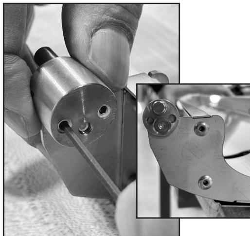
3b. Ziehen Sie auf der Innenseite des Adapters mit dem 2-mm-Sechskantschlüssel und mit dem Adapterpfosten in der höchsten Position (12 Uhr) die beiden Stellschrauben fest (Stellschrauben sind im Lieferumfang des Adapters enthalten).
