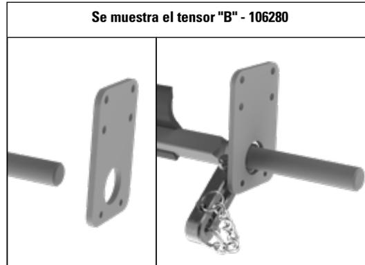
2. Deslice el eje del limpiador hasta que el extremo redondo quede dentro de la placa lateral, deslice la palanca de bloqueo sobre el eje y después vuelva a insertar el eje a través de la placa lateral. No apriete el perno de mordaza de la palanca.
