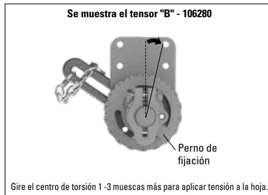
4. Coloque la palanca en una posición accesible casi a 30° del nuevo agujero en la dirección de la pretensión y apriete el perno de la mordaza de la palanca de bloqueo. Asegúrese de que la palanca de bloqueo esté apretada en el eje del limpiador. Accione la palanca para alejar la hoja de la banda y bloquéela en su sitio colocando el pasador que se suministra a través de la ranura de la palanca y el orificio de 5/16" (8 mm). Pruebe el transportador según IOM.
