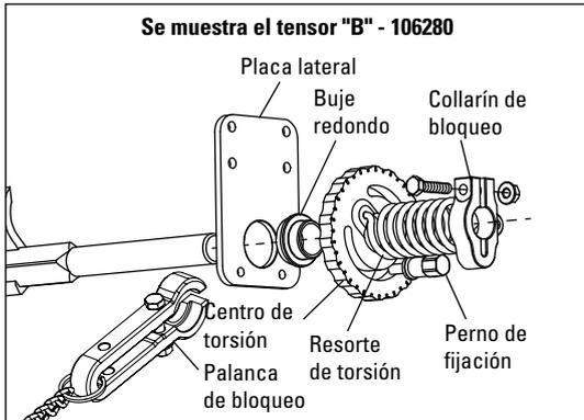
1. Afloje y quite con cuidado el perno de fijación del tensor, después afloje el collarín de bloqueo y quite la unidad del tensor del limpiador.
