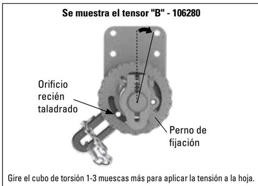
3. Ajuste la torsión en el tensor según IOM del limpiador, X6381 para FGS o W1603 para FGP-ES. Después de ajustar la pretensión pero antes de apretar el perno de la mordaza de la palanca, determine la posición de la palanca cuando la hoja esté alejada de la banda. Taladre uno de los orificios roscados M8 usando una broca de 5/16" (8 mm) de diámetro en la placa lateral alineada con la ranura de la palanca de bloqueo.
