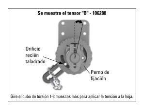
3. Ajuste la torsión en el tensor según IOM del limpiador, X6385 para FGS o W1600 para FGP-ES. Después de ajustar la pretensión pero antes de apretar el perno de la mordaza de la palanca, determine la posición de la palanca cuando la hoja esté alejada de la banda. Taladre uno de los orificios roscados M8 usando una broca de 5/16" (8 mm) de diámetro en la placa lateral alineada con la ranura de la palanca de bloqueo.
