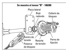
Afloje y quite con cuidado el perno de fijación del tensor, después afloje el collarín de bloqueo y quite la unidad del tensor del limpiador.
