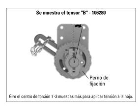
4. Coloque la palanca en una posición accesible casi a 30° del nuevo agujero en la dirección de la pretensión y apriete el perno de la mordaza de la palanca de bloqueo. Asegúrese de que la palanca de bloqueo esté apretada en el eje del limpiador. Accione la palanca para alejar la hoja de la banda y bloquéela en su sitio colocando el pasador que se suministra a través de la ranura de la palanca y el orificio de 5/16" (8 mm). Pruebe el transportador según IOM.
