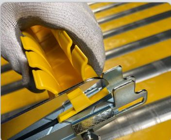
**Cortador de placa de transferencia para cortar la placa de transferencia a la longitud deseada**
