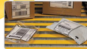
*Las placas de transferencia lisas aseguran el movimiento continuo entre rodillos para mantener el flujo de producto.*
