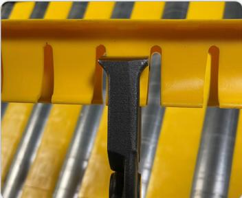
**Cortador de muescas de patas se usa para cortar las patas en su base justo detrás de la longitud de placa deseada**
