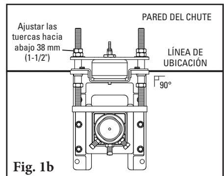
1. **Instale las bases de montaje del tensor de aire y agua.** Con una mordaza coloque la base de montaje en posición de manera que la base esté al ras con la banda (Fig. 1a). Atornille la base de montaje en el lugar. Ubique e instale la base de montaje en el lado opuesto.
