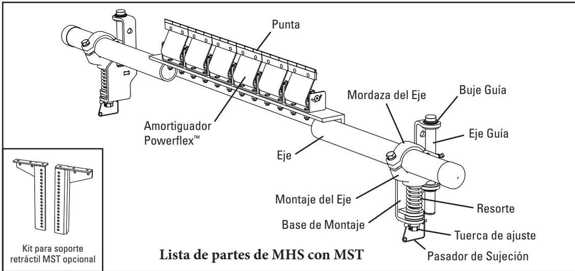
**Etiquete y bloquee físicamente el transportador en la fuente de energía antes de empezar la instalación del limpiador.**
