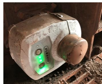
Monter le dispositif orienté vers l'extérieur de l'axe
