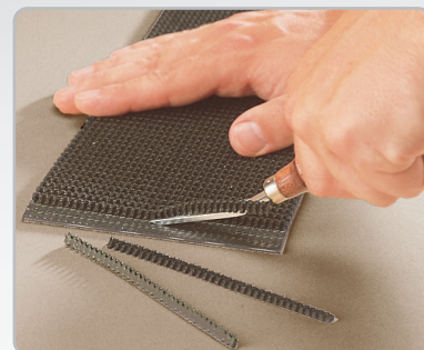
Raschiare via lo strato di rivestimento superiore.
