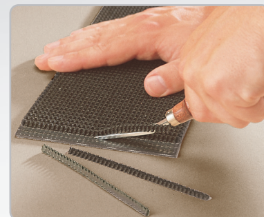
Raschiare via lo strato di rivestimento superiore.
