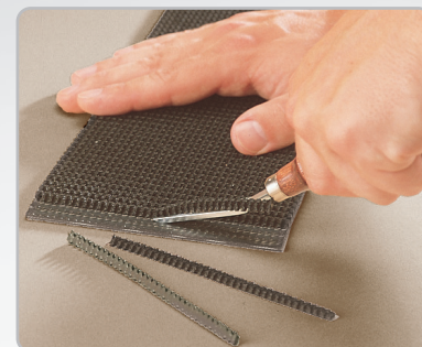
Raschiare via lo strato di rivestimento superiore.
