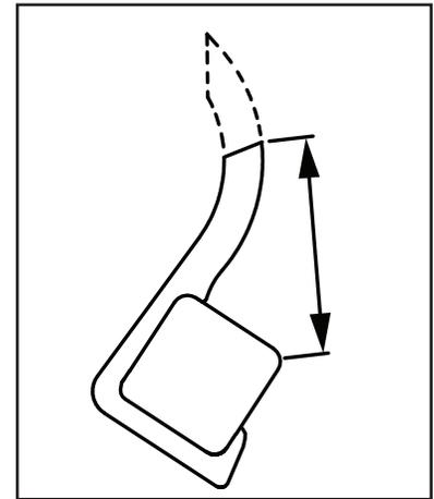
Medida del desgaste de la hoja con un medida de cinta adhesiva - Punta de la hoja a la esquina de la barra
