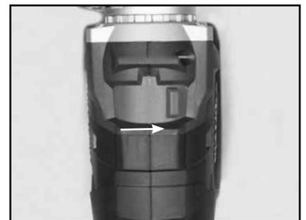
3. Ajuste de la velocidad de corte; ajuste el taladro eléctrico para reducir la velocidad moviendo el interruptor a velocidad baja. Para obtener mejores resultados siempre opere el desbastador en baja velocidad.
