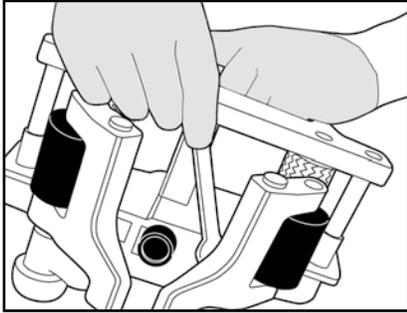
**Cambio de la hoja:** gire el tornillo de ajuste de la hoja para levantar la hoja y gire el tornillo de ajuste de la mordaza para bajar los rodillos de agarre. Con una llave inglesa de  $\frac{7}{16}$ , quite el tornillo  $\frac{1}{4}$ -20 del sujetador de la hoja.
