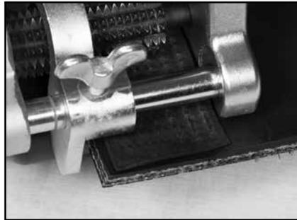
7. Al desbastar, los pedazos recortados deben permanecer en contacto con la banda. El pedazo recortado y la banda deben pasar debajo de los rodillos impulsores traseros.
