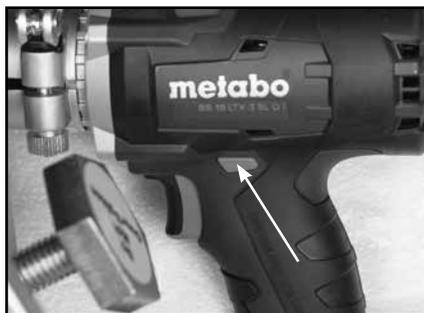
1. Para uso normal opere en dirección inversa, presione el botón de dirección de perforación para operarla en dirección inversa.
