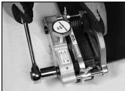
6. Anote la dirección de desbaste y coloque la herramienta en reversa. Una vez la banda llega a los rodillos impulsores traseros, gire el tornillo de ajuste de la mordaza hacia la izquierda 1/4 de vuelta.
