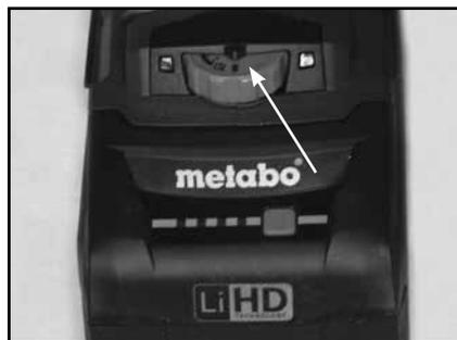
2. Opere únicamente en el modo de torque máximo; gire el marcador para indicar modo de taladro.
