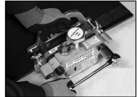
8. Ponga en funcionamiento el desbastador de una manera controlada por todo el ancho de la banda. Asegúrese de que la banda esté contra la barra protectora. Ponga en funcionamiento el desbastador completamente fuera de la banda para completar el corte. Retire el corte. Repita los pasos del 1 al 8 en el otro extremo de la banda.
