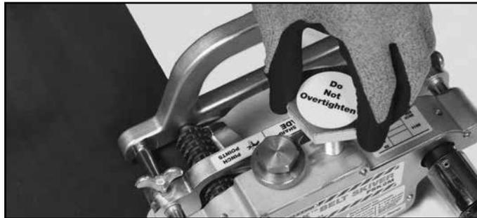
4. Gire el tornillo de ajuste de la mordaza hacia la izquierda para aflojar los rodillos de sujeción. Coloque el borde de la banda contra la barra protectora, la banda solo debe tocar el borde de la hoja.
