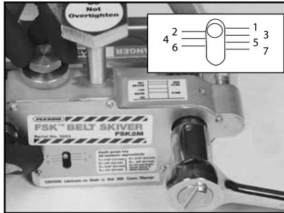
2. Para una herramienta nueva quite con cuidado el recubrimiento de protección de la hoja. Gire el tornillo de ajuste de la hoja para seleccionar la profundidad de corte deseada. Apriete la contratuerca de tensión.
