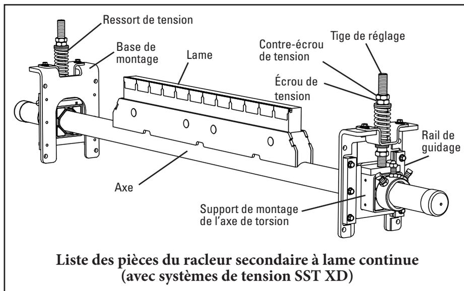
**Cadenassez le convoyeur et étiquetez sa source d'alimentation avant de commencer l'installation du racleur.**
