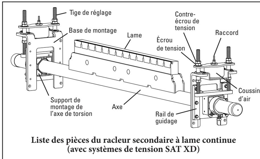
***Cadenassez le convoyeur et étiquetez sa source d'alimentation avant de commencer l'installation du racleur.***
