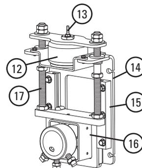
11 Système de tension secondaire à air XD
