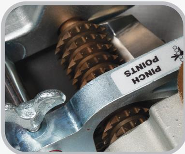
Rodillos impulsores delanteros que sujetan fuertemente la banda al inicio de la rebaja para evitar deslizamientos.
