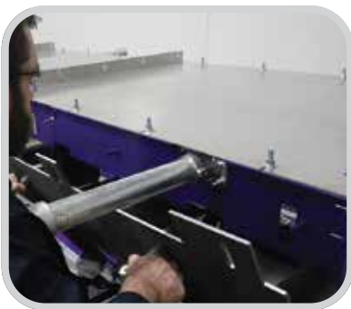
可在外部更换耐磨衬板， 易于维护
