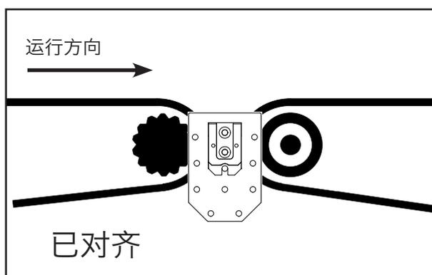
3. 按照 X4064 中的说明插入支撑杆和支架。使用支架上的背胶将支架放置到位。
