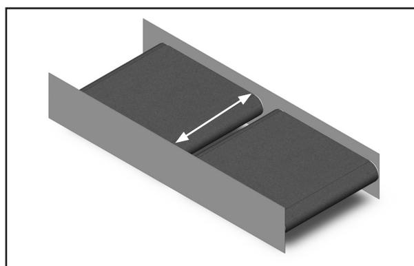
2. 测量机架的内部宽度，以确定支架的放置位置。
