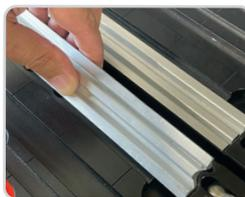
交換可能なスプライステンプレートにより、異なるベルトメーカーのベルトピッチに合わせて、正確なスプライシング加工を行えます
