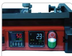
デジタルタイム制御と、迅速かつ簡単なスプライス設定。予熱設定を用いることで湿気を取り除き、ピンホールの発生を防ぎます
