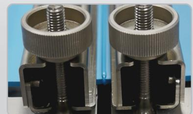
**Zona de enfriamiento:** El calefactor guarda y enfría la unidad interior a medida que los extremos de la banda se empalman entre sí.
