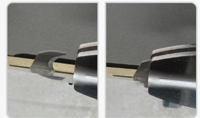
**Posición de almacenamiento de la cortadora:** La cortadora debe estar en la posición de almacenamiento para que opere la función de empalme.
