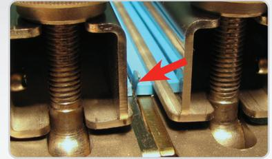
**Cortador integrado:** El operador está protegido de la hoja durante la operación de corte de una sola pasada.
