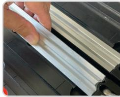
Plantillas de empalme intercambiables para el ángulo de inclinación preciso del empalme de las bandas de varios fabricantes de bandas
