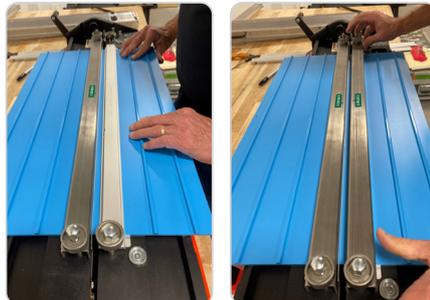
El Juego de empalmes de lado de retorno incluye componentes para permitir el empalme con Amigo en el lado de retorno del transportador.
