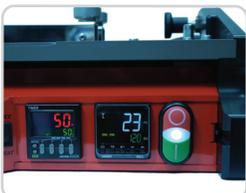
Control digital de tiempo con configuraciones de empalme sencillas y rápidas; la configuración de precalentamiento se puede usar para eliminar la humedad y evitar las perforaciones
