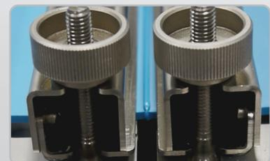
**Zona de enfriamiento:** El calefactor guarda y enfría la unidad interior a medida que los extremos de la banda se empalman entre sí.
