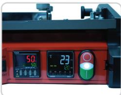
Digitale Zeiteinstellung mit schnellen, einfachen Verbindungseinstellungen; die Vorwärm-Einstellung kann zum Entfernen von Feuchtigkeit und zur Verhinderung von Lufteinschlüssen verwendet werden
