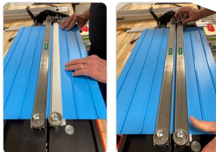
Das Rücklaufseiten-Spleißset enthält Komponenten, die das Spleißen mit dem Amigo auf der Rücklaufseite des Förderers ermöglichen.
