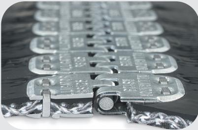
Der Alligator® Staple-Verbinder wurde für Bänder mit synthetischer Karkasse für leichte und mittlere Beanspruchung entwickelt. Für diese Verbinder werden Edelstahlklammern mit hoher Zugfestigkeit in Kombination mit einem erweiterten Plattendesign verwendet. Bei diesem Design sind der Durchsteckpunkt des Verbinders und die Knicklinie des Bandes voneinander separiert, sodass eine Materialermüdung der Verbinder an den Befestigungspunkten am Band verhindert wird.
