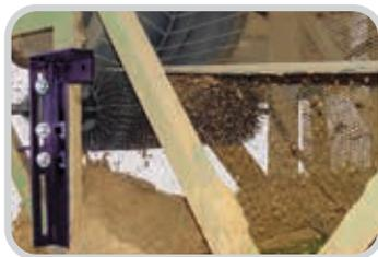
50mm (2") 橡胶齿可轻轻除去人字形或棱条输送带上的回传带料
