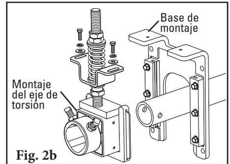
(Fig. 2a). Si no hay suficiente espacio, quite uno de los montajes del eje de torsión de la base de montaje, deslice el eje a través de la base de montaje y vuelva a ensamblar (Fig. 2b).
