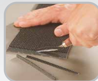
Desbaste la cubierta de impresión.
