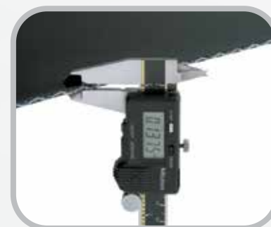
Mida el espesor de la banda.
