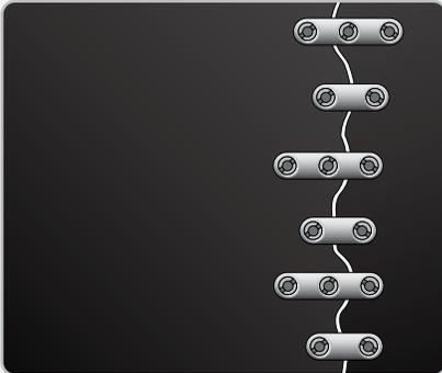
Para desgarres dentados longitudinales del transportador de banda o para conectar puntos suaves, las grapas placa sólida atomillada estándar se pueden combinar con grapas de reparación de desgarres de tres tornillos.
