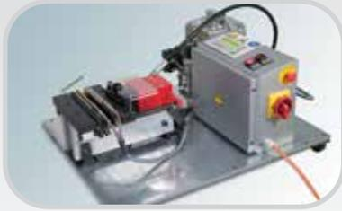
El ARK-150-WNP hidráulico y eléctrico ofrece la metodología más rápida y sencilla para la instalación de grapas de parche. La grapa incluye tanto una estación de enfriamiento como una estación de presión/calefacción
