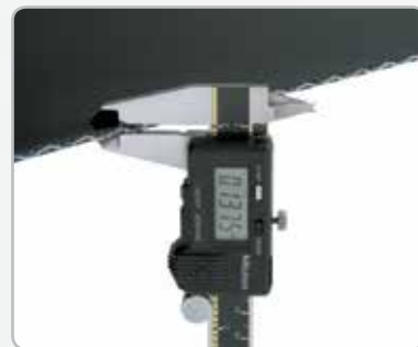
Mida el espesor de la banda.
